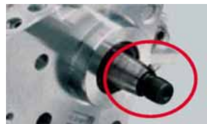
Poškodbe na pogonski gredi
