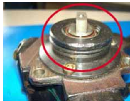
Poškodbe na pogonski prirobnici
