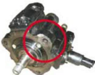
Poškodbe na ohišju
